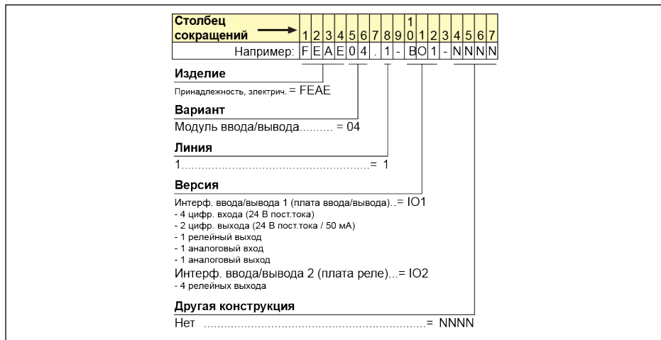
Рис. 19-6: Типовой код модуля ввода-вывода
